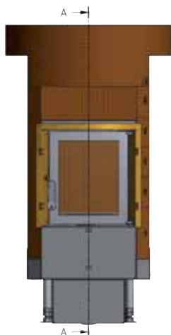
Perfekte Luftführung für saubere Scheibe und saubere Verbrennung. Mit externem Zuluftanschluss \varnothing 125 mm.
